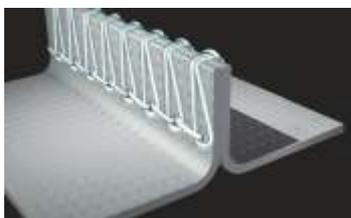
Данная технология предполагает соединение элементов ткани крепкой нитью. Это самый экономичный, и как следствие, очень распространённый метод. Обметанный шов не применяется при изготовлении одежды химической защиты. Как правило, такие швы используются только при изготовлении одежды ограниченного срока применения, защищающей от сухих веществ.
